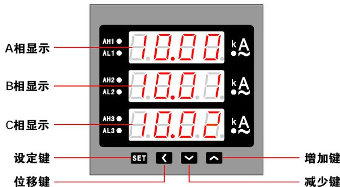
注: k指示灯被点亮时,表示仪表单位已被切换到kA; AH1、AH2、AH3指示灯被点亮时,分别表示仪表A、B、C相电量示值已超过上限报警设定值; AL1、AL2、AL3指示灯被点亮时,分别表示仪表A、B、C相电量示值已低于下限报警设定值;
